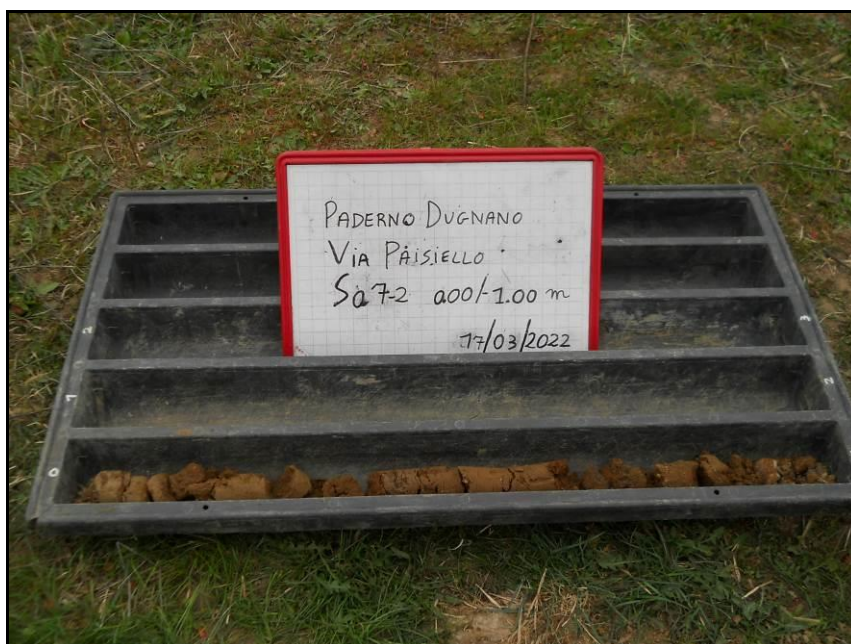
Foto 5 e 6: esecuzione del carotaggio Sa7-2 e visione della cassetta con il materiale prelevato da 0.00 a -1.00 m, il top della sequenza è in basso a sinistra.
