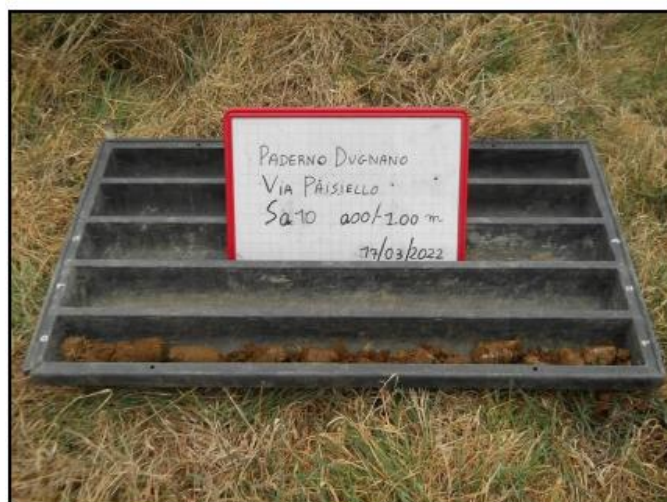
Figura 10 – Sondaggio Sa10 - cassetta catalogatrice con il materiale prelevato da 0.00 a -1.00 m
