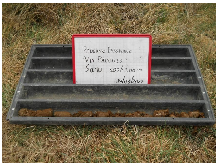
Foto 9 e 10: esecuzione del carotaggio Sa10 e visione della cassetta con il materiale prelevato da 0.00 a -1.00 m, il top della sequenza è in basso a sinistra.
