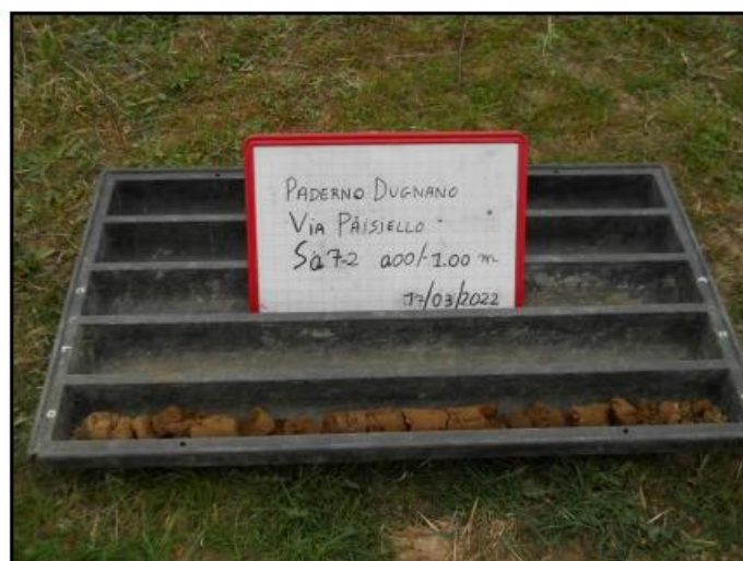
Figura 6 – Sondaggio Sa7-2 - cassetta catalogatrice con il materiale prelevato da 0.00 a -1.00 m
