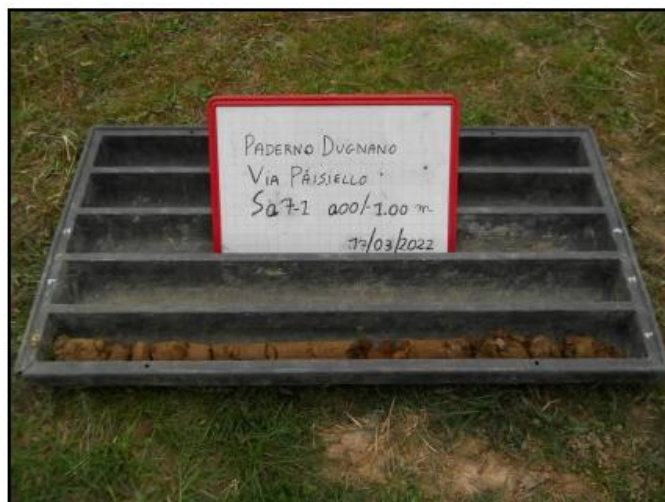
Figura 4 – Sondaggio Sa7-1 - cassetta catalogatrice con il materiale prelevato da 0.00 a -1.00 m
