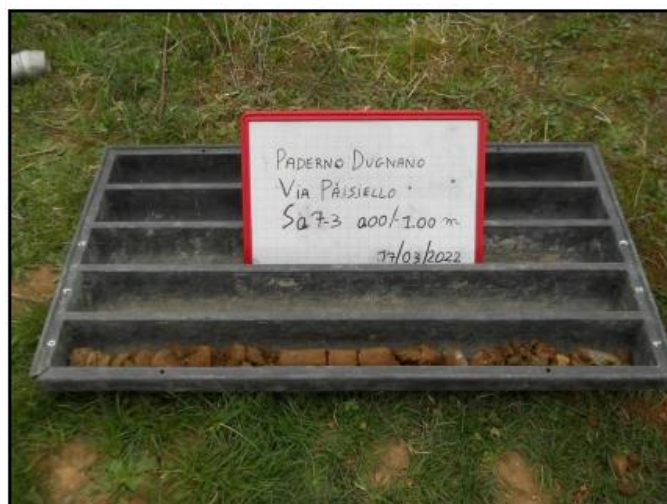
Figura 8 – Sondaggio Sa7-3 - cassetta catalogatrice con il materiale prelevato da 0.00 a -1.00 m
