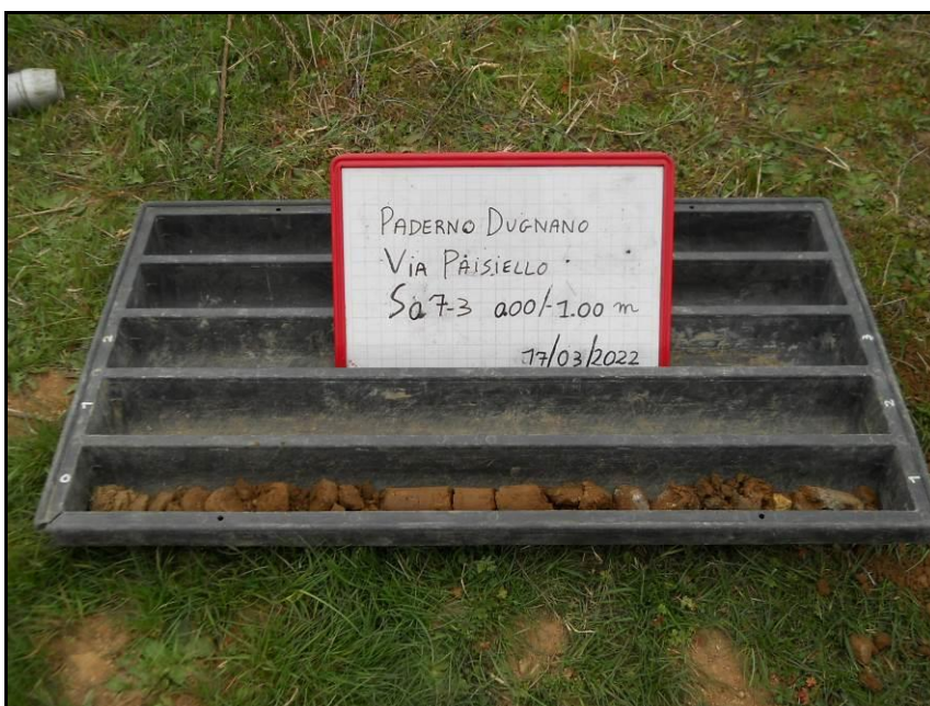
Foto 7 e 8: esecuzione del carotaggio Sa7-3 e visione della cassetta con il materiale prelevato da 0.00 a -1.00 m, il top della sequenza è in basso a sinistra.
