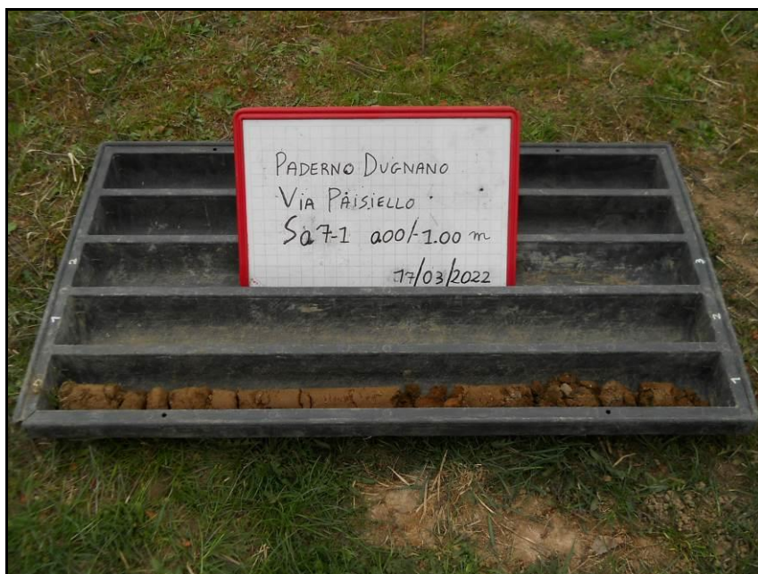
Foto 3 e 4: esecuzione del carotaggio Sa7-1 e visione della cassetta con il materiale prelevato da 0.00 a -1.00 m, il top della sequenza è in basso a sinistra.
