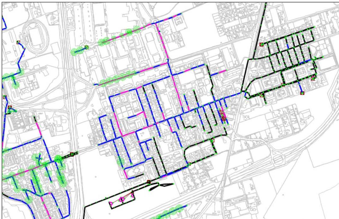
Figura 13. Criticità associate ad evento di pioggia di tipo Chicago in stato di progetto – frazione di Calderara (Tr= 10 anni)
