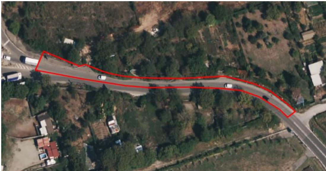
Figura 34. Bacino afferente alla trincea drenante in progetto
