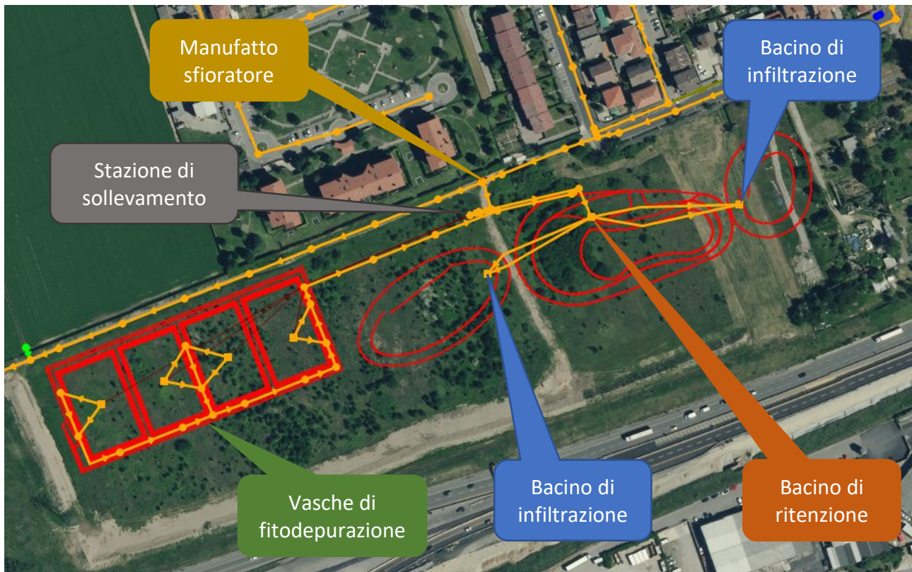
Figura 11. Modello idraulico degli interventi in progetto. In rosso sono rappresentate le aree in progetto
