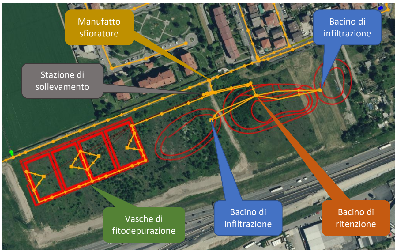
Figura 1. . Modello idraulico degli interventi in progetto. In rosso sono rappresentate le aree in progetto
