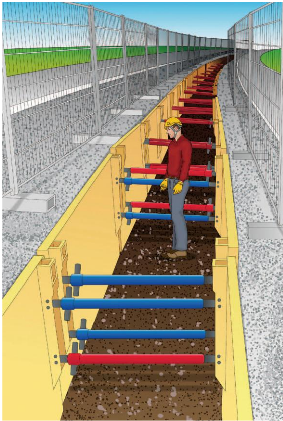
Figura 10. Schema tipologico armatura di scavo
