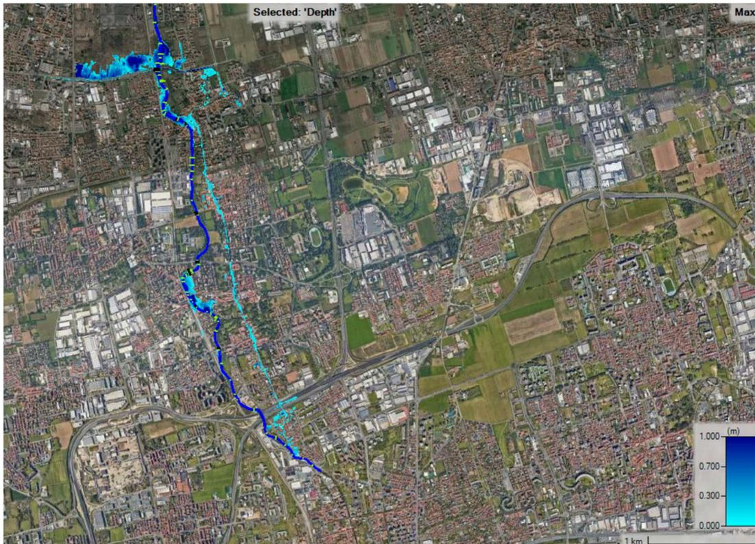
Figura 6.7 – Tiranti idrici con piena centennale del torrente Seveso
