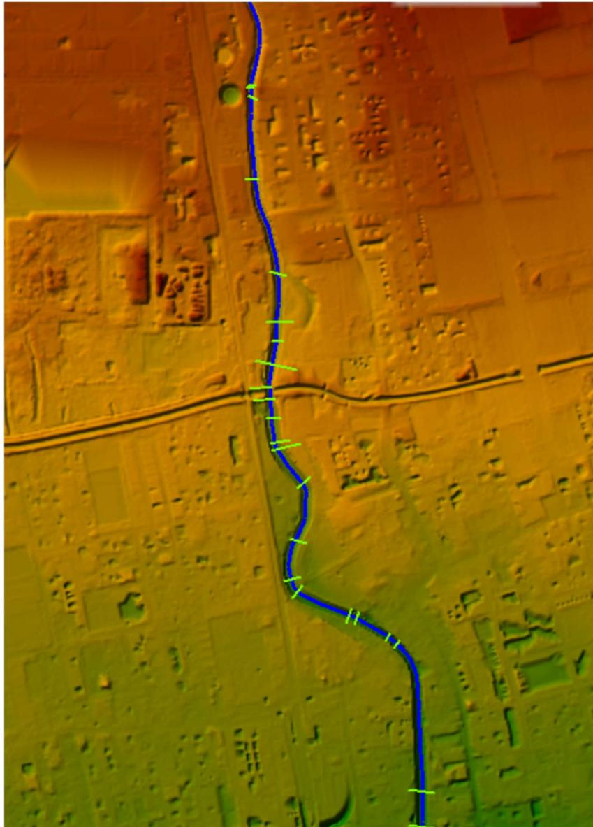
Figura 6.1 – Stralcio modello digitale del terreno utilizzato per la ricostruzione geometrica dell'alveo
