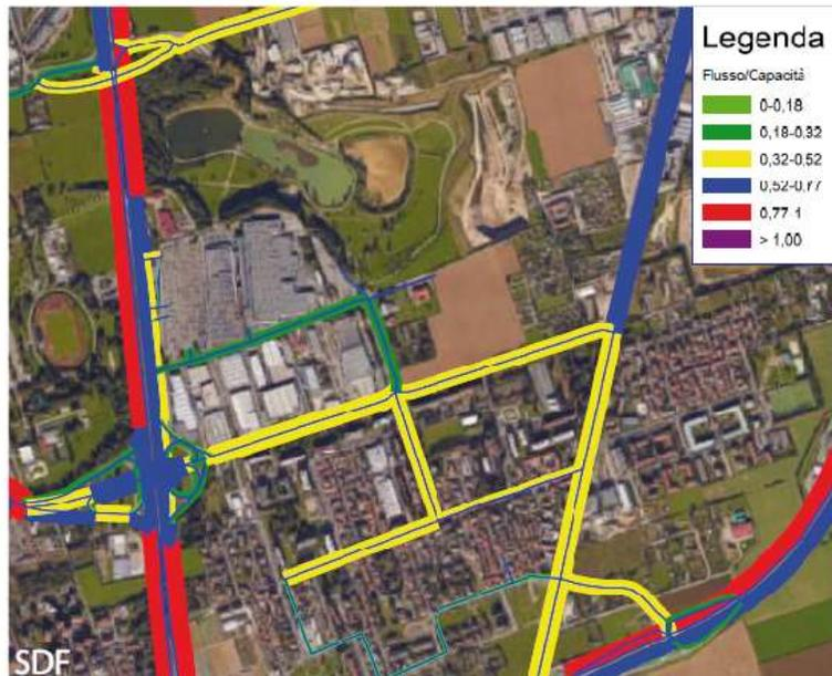
Figura – flussogramma flusso/capacità della rete SDF (ora di punta sabato sera) (da Studio del traffico - integrazioni)
