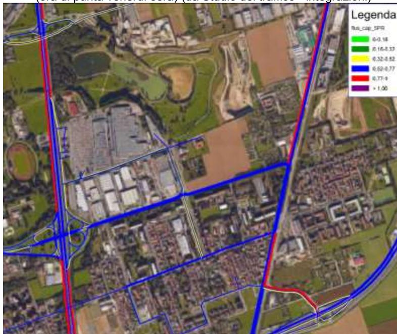
Figura – flussogramma flusso/capacità della rete nello scenario SPR
