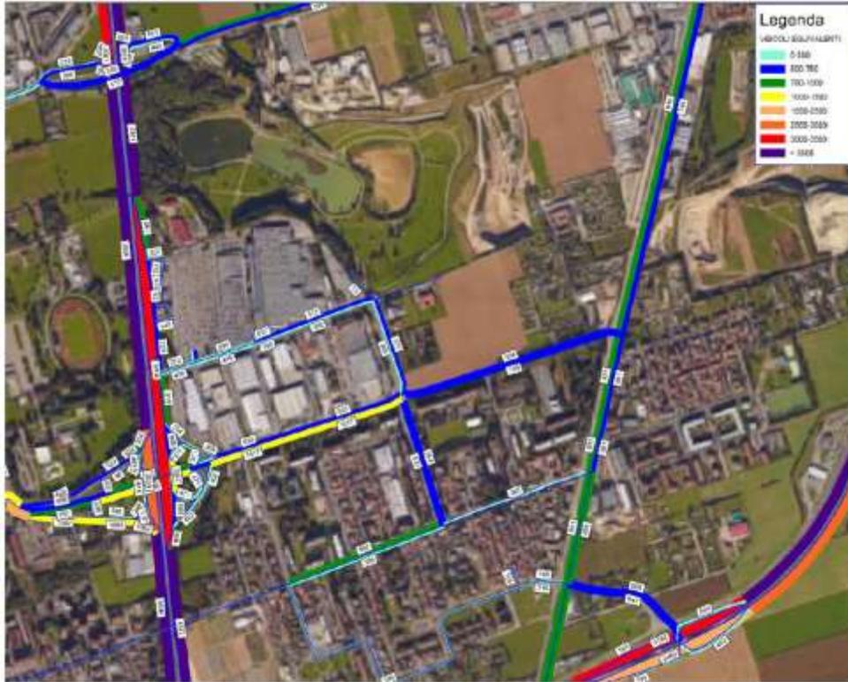
Figura –Flussogramma di carico SDF ora di punta del sabato sera (da Studio del traffico)
