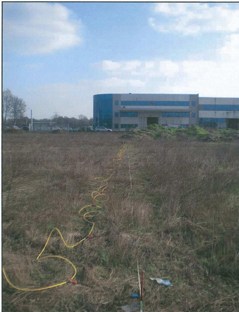
**Figura 3:** Vista dello stendimento MASW effettuato.
