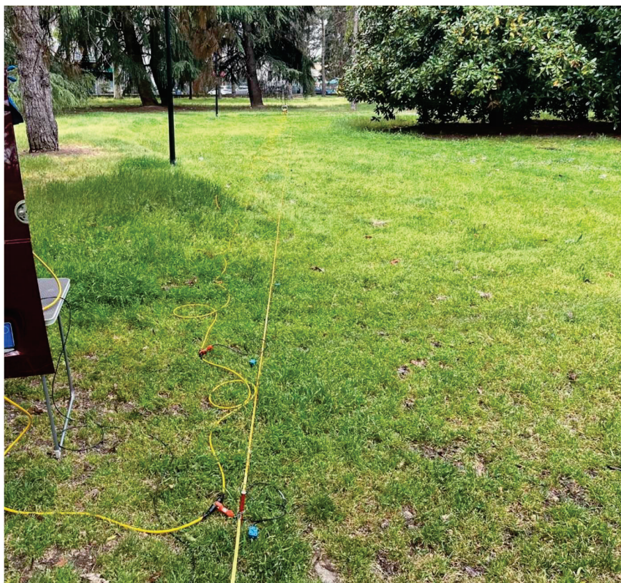
Vista dello stendimento MASW 1 – Area A1.
