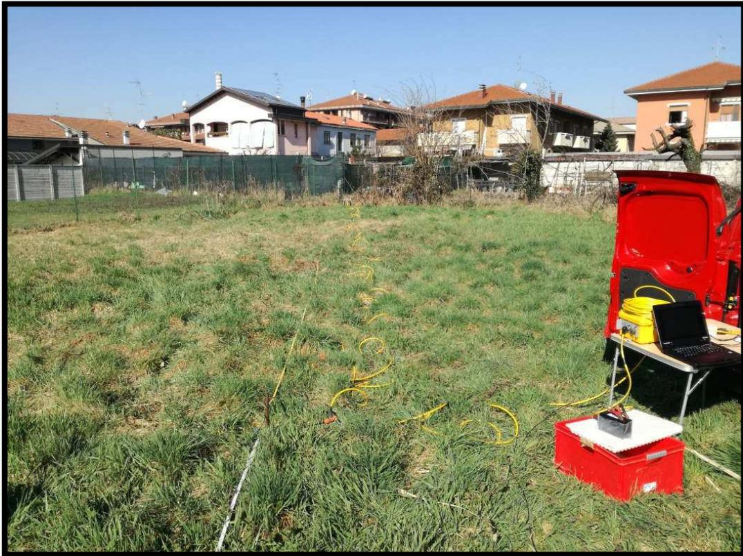
**Figura 5.2** - Vista dello stendimento MASW effettuato.
