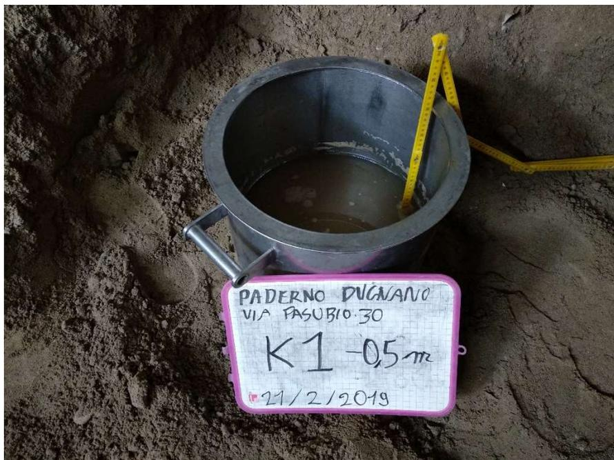
Figura 3.1 – Esecuzione prova K1 mediante infiltrometro.
