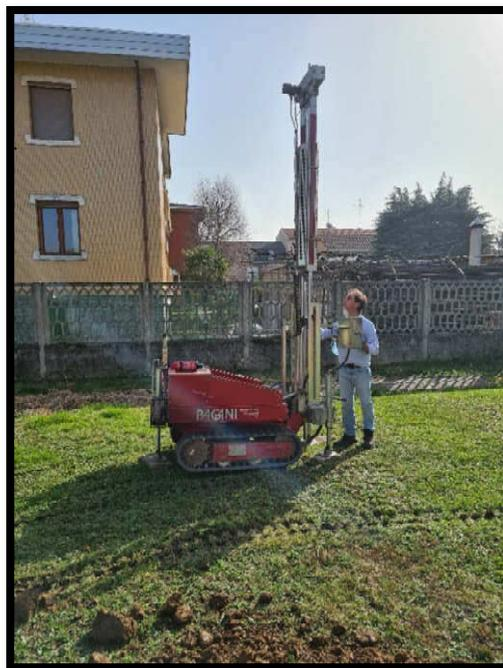
Figura 4.1 – Prova penetrometriche P1
