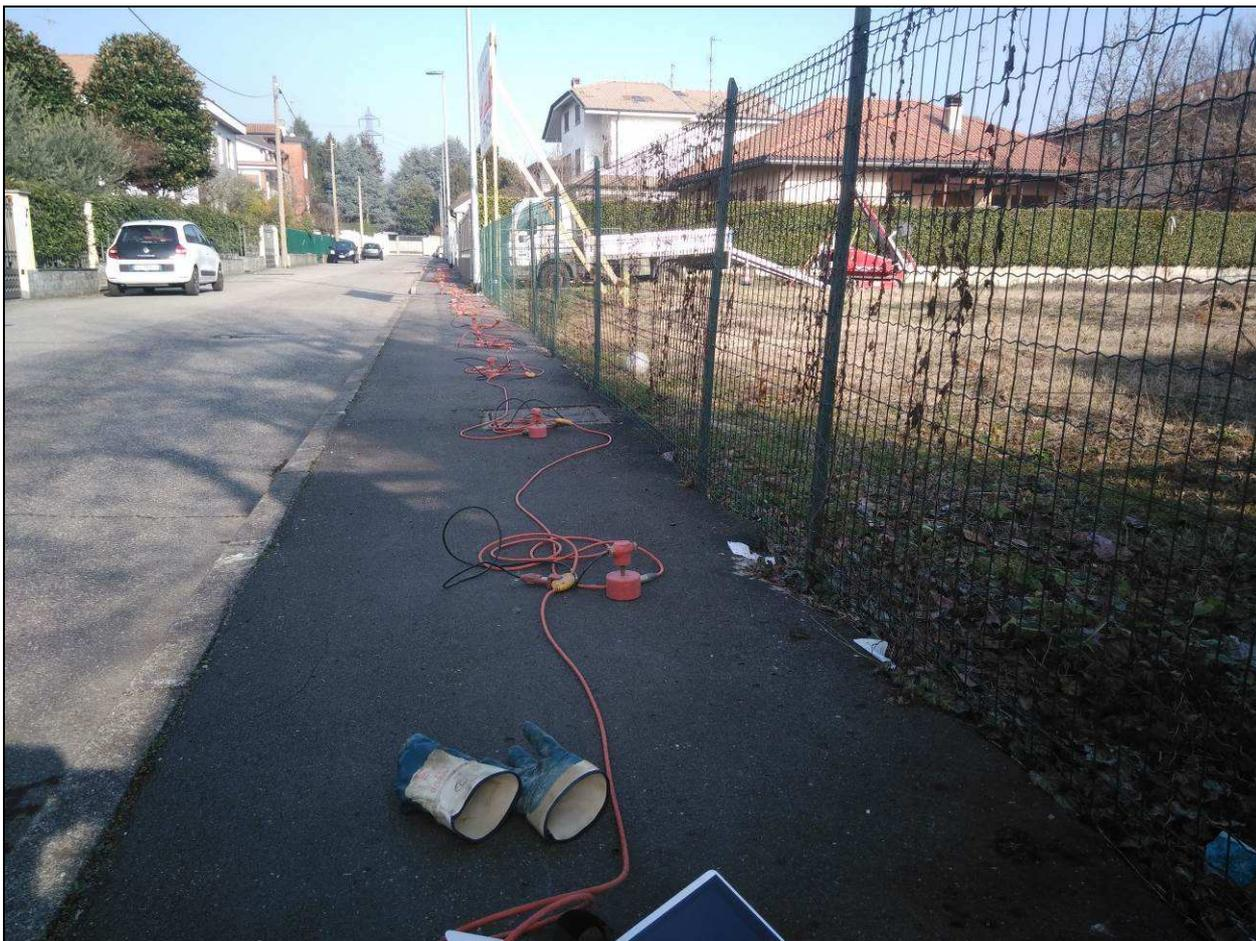
Vista dello stendimento sismico
