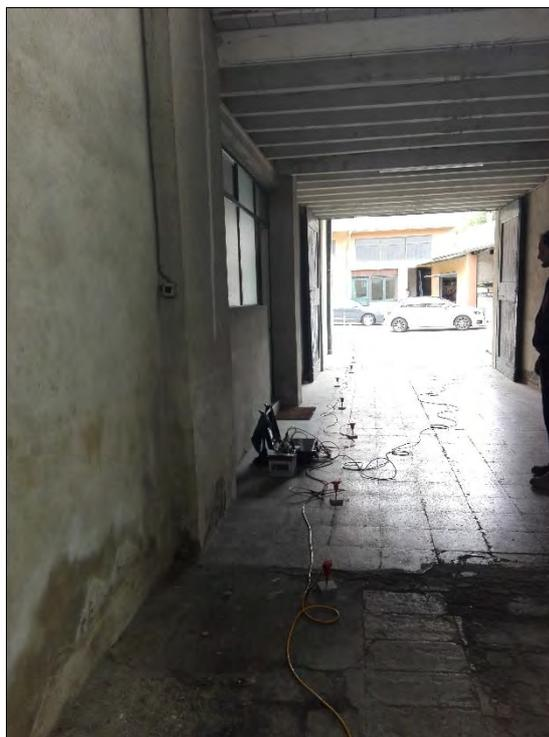
Figura 3-2 Prova MASW - sismografo e stendimento geofoni
