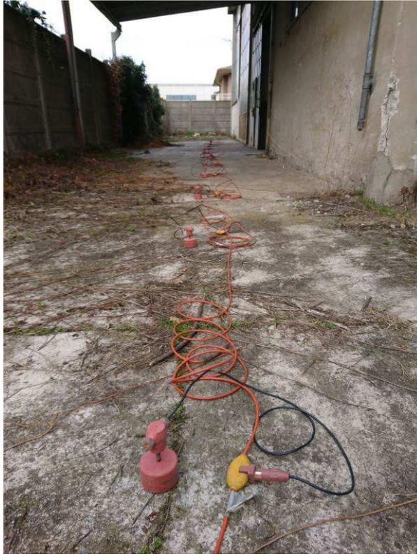
Vista dello stendimento sismico
