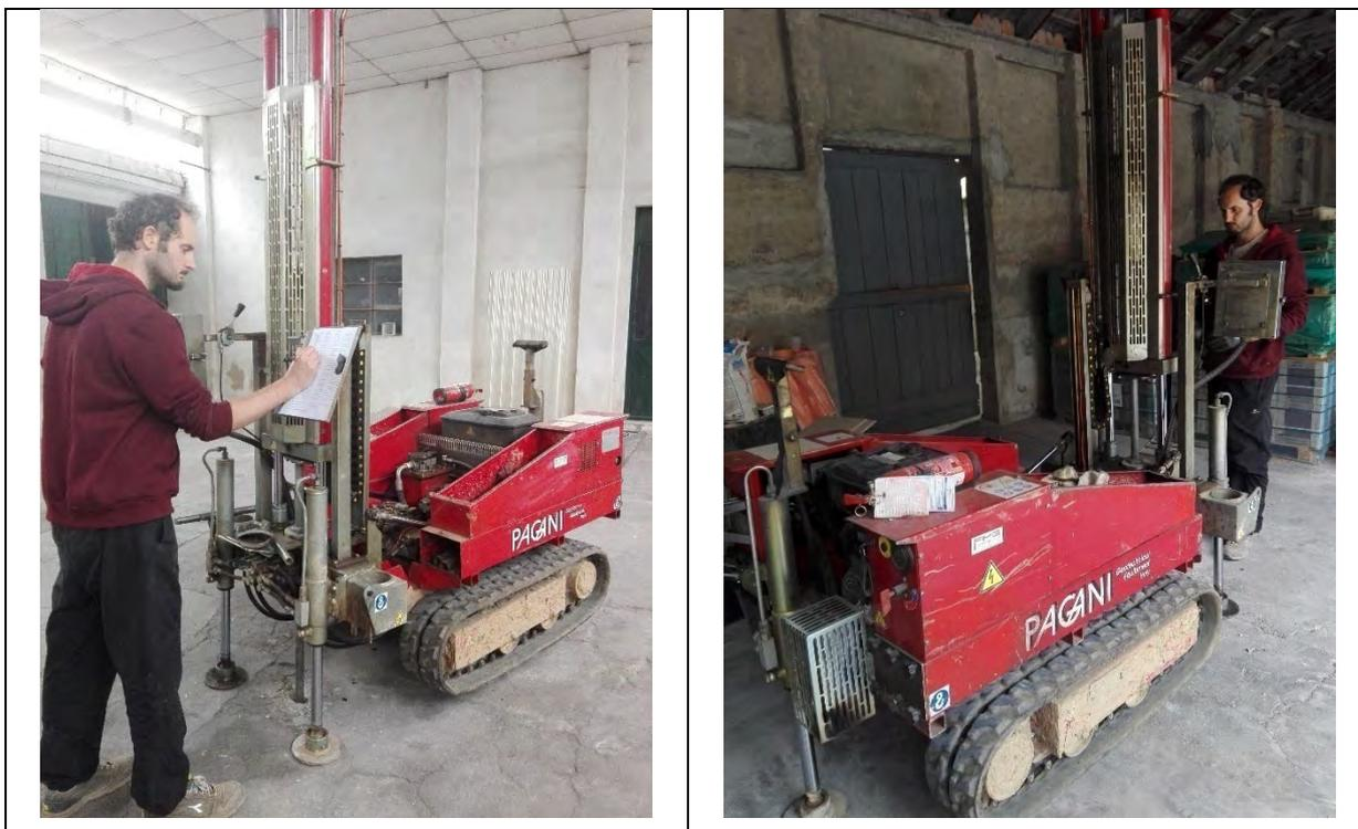
Figura 3-1 esecuzione delle prove penetrometriche
