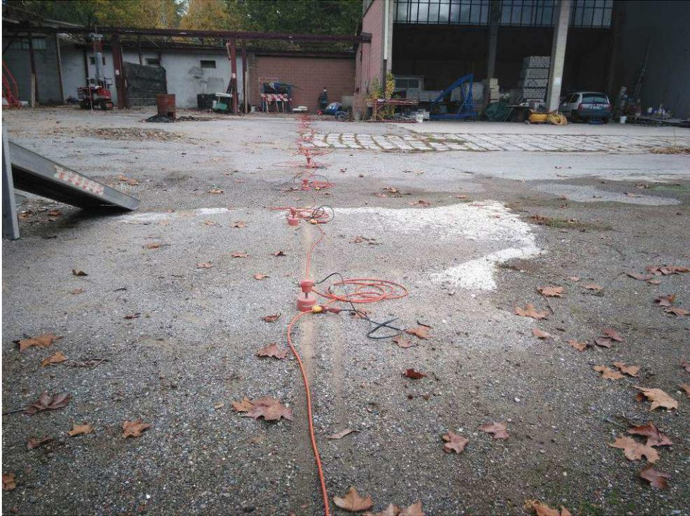
Vista dello stendimento sismico
