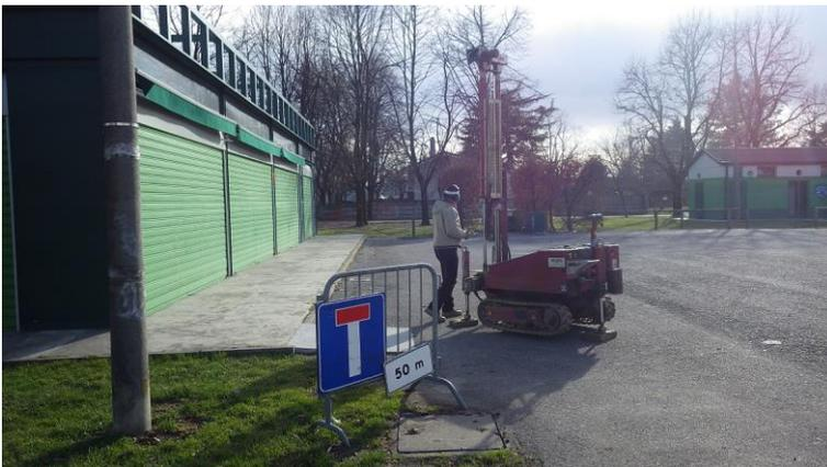
*Fig. 10 - Indagine diretta con prove penetrometriche*
