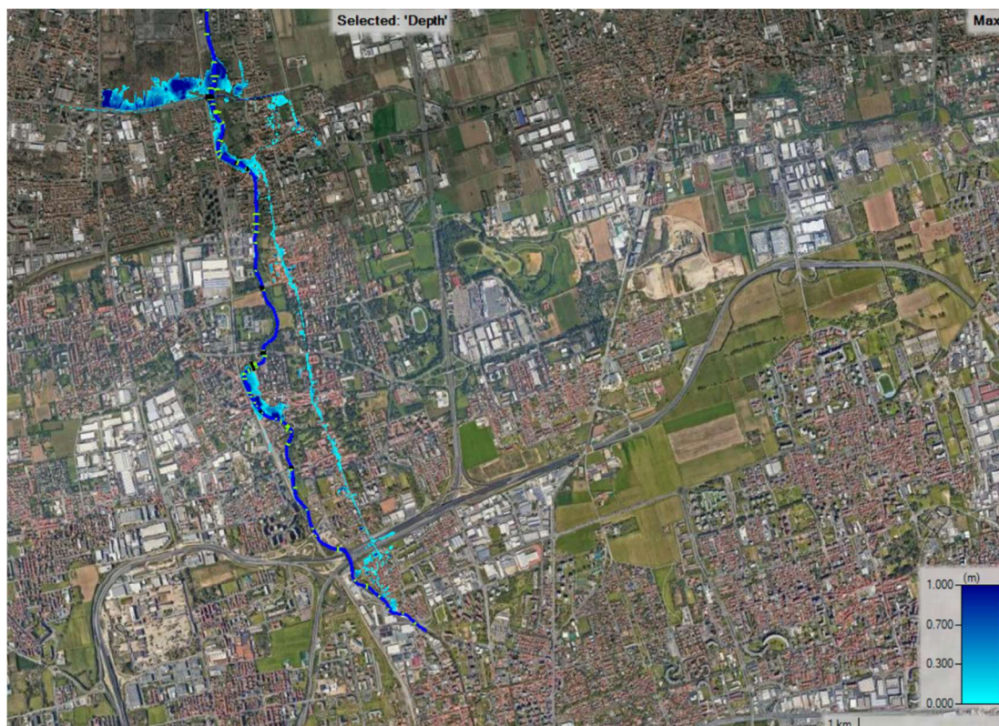
Figura 6.7 – Tiranti idrici con piena centennale del torrente Seveso
