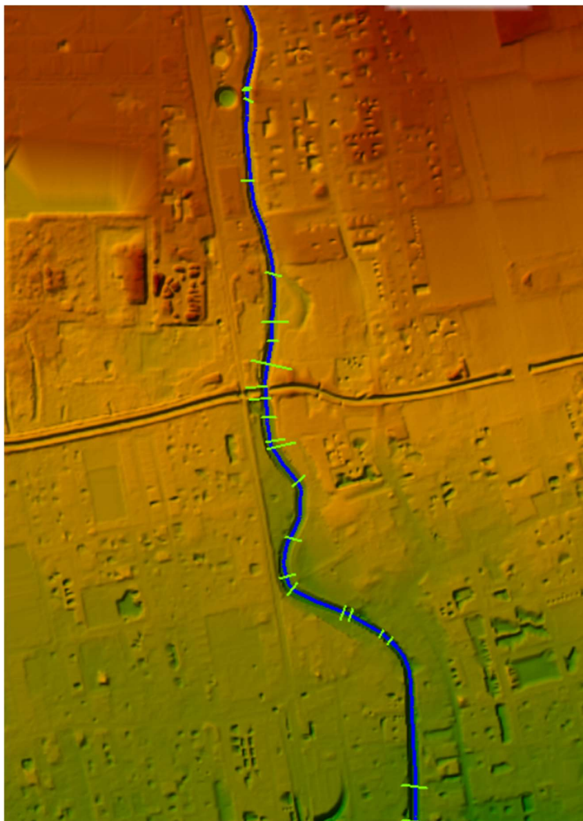
Figura 6.1 – Stralcio modello digitale del terreno utilizzato per la ricostruzione geometrica dell'alveo Sulla base del DTM così implementato sono inserite 60 sezioni rilevate e una serie di sezioni trasversali interpolate che sono state utilizzate nel modello per la descrizione monodimensionale dell'alveo. Sono quindi stati inseriti i manufatti di attraversamento presenti lungo il corso d'acqua.
