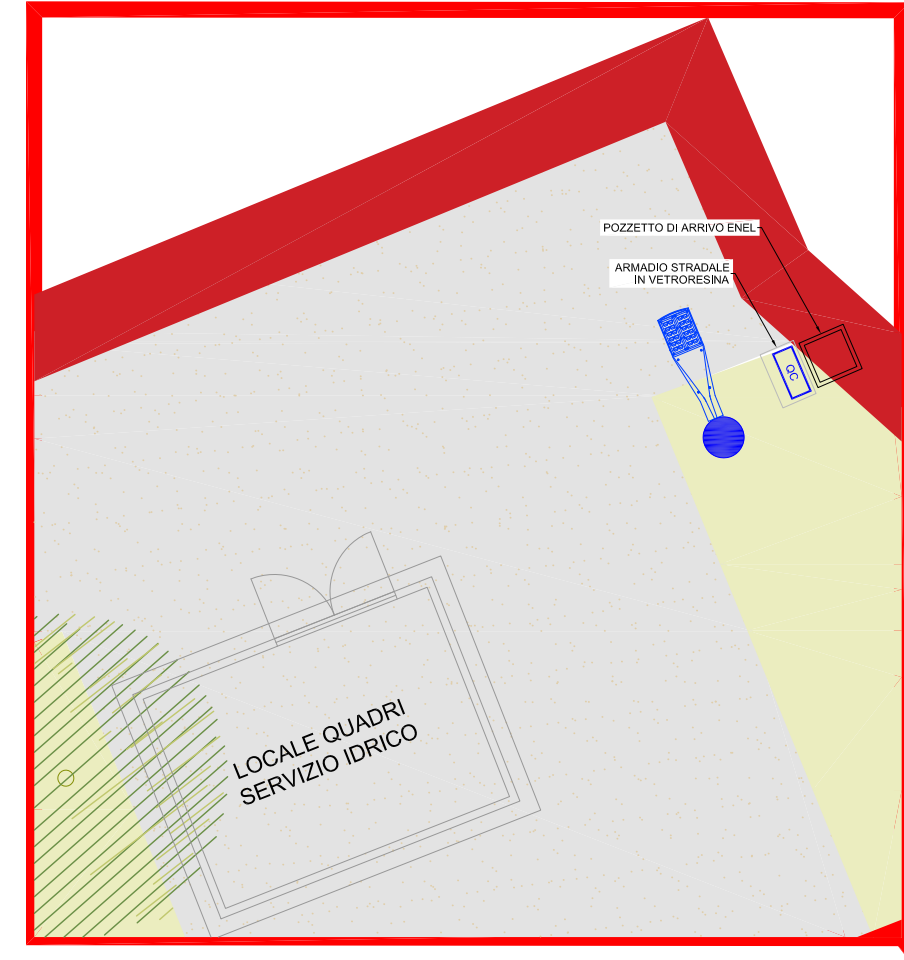
PARTICOLARE ZONA CONSEGNA SERVIZIO IDRICO - SCALA 1:100
