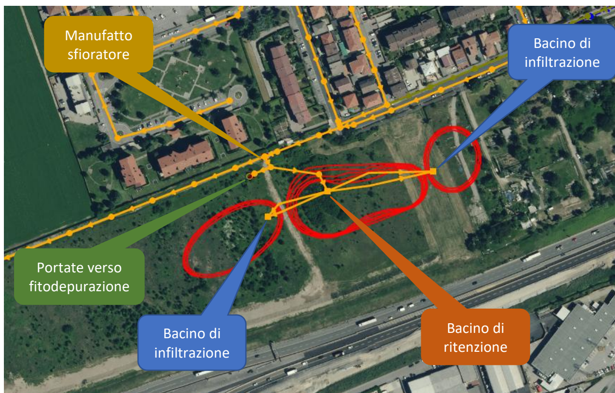
Figura 11. Modello idraulico degli interventi in progetto. In rosso sono rappresentate le aree dei bacini in progetto
