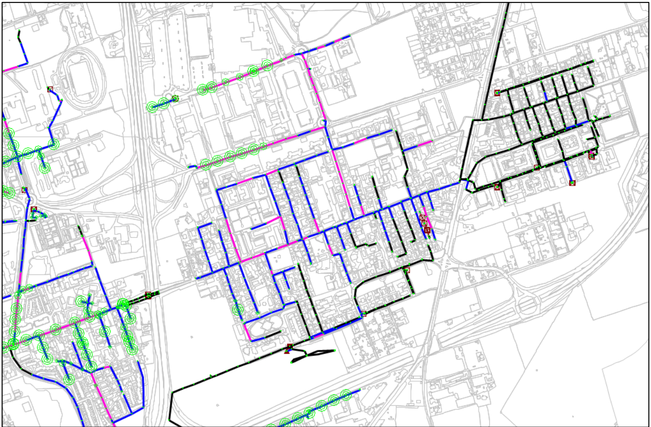
Figura 12. Criticità associate ad evento di pioggia di tipo Chicago in stato di progetto – frazione di Calderara (Tr= 10 anni)
