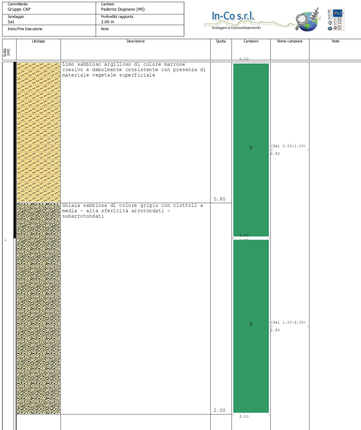
Figura 13. Stratigrafia del sondaggio Sa1.
