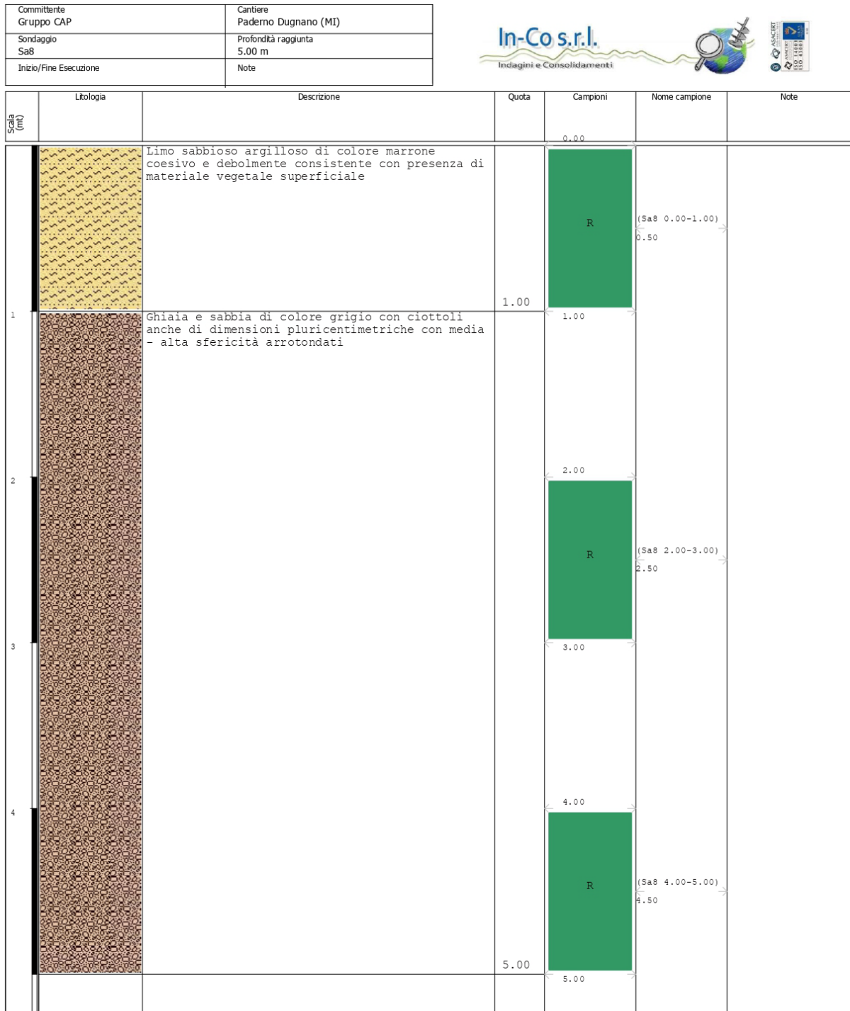
Figura 20. Stratigrafia del sondaggio Sa8.
