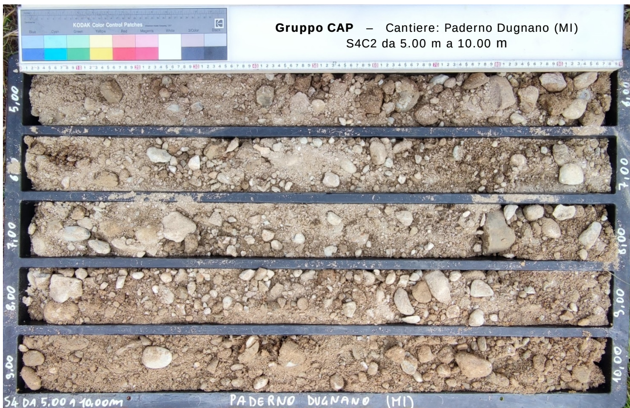
Foto 8. Sondaggio S4 da 5.00 m a 10.00 m.
