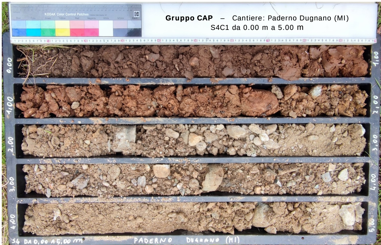
Foto 7. Sondaggio S4 da 0.00 m a 5.00 m.
